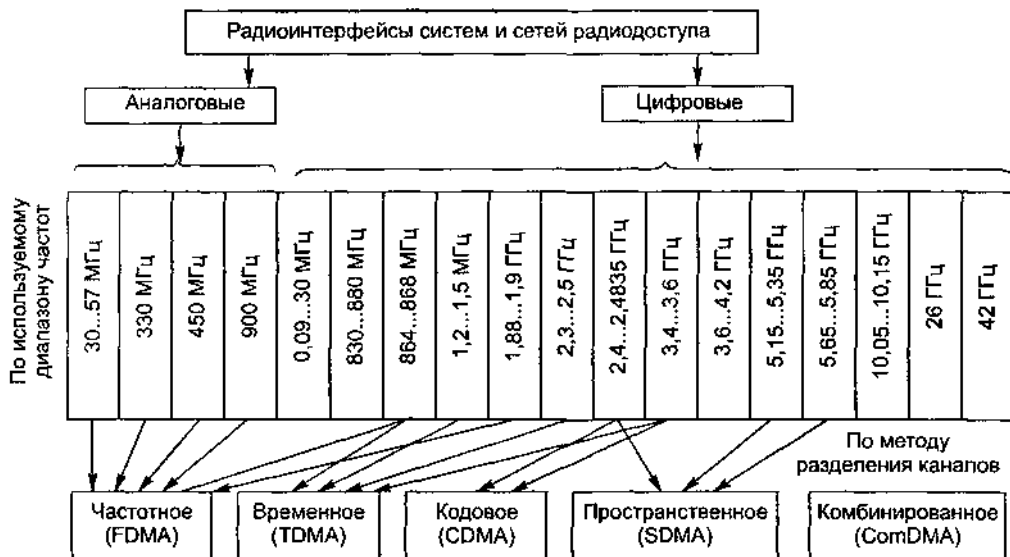
Рис. 3.16. Параметры радиоинтерфейса современных систем радиодоступа
