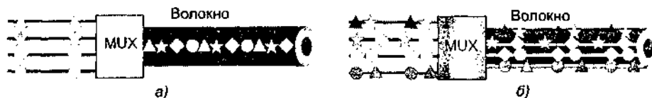
Рис. 4.5. Передача сигналов по оптоволокну: а — на одной длине волны (технология TDM); б — на нескольких длинах волн одновременно (технология WDM)
